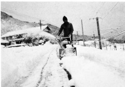
▲五馬力の除雪車は、雪を吹き飛ばしながら
