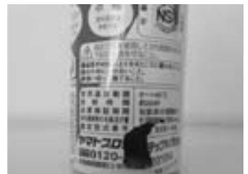
去る5月に、米子市内において、ヤマトプロテック(株)製のエアゾール式簡易消火具の容器破裂事故が発生しましたので、ご注意ください。(写真参考)
