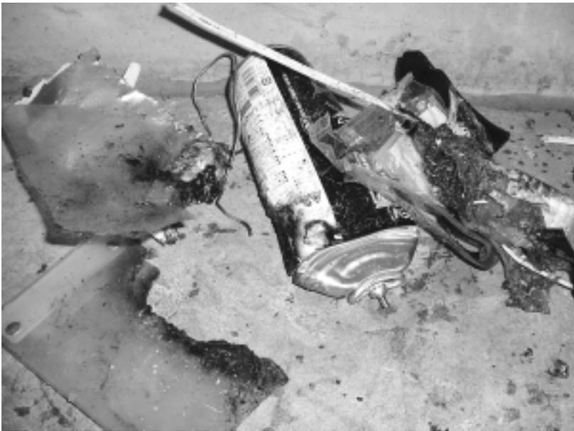
1月20日（金）午前11時10分ごろ、リサイクルプラザの不燃ごみ前処理破砕機内において、爆発したカセット式ガスボンベと類焼の状況。
